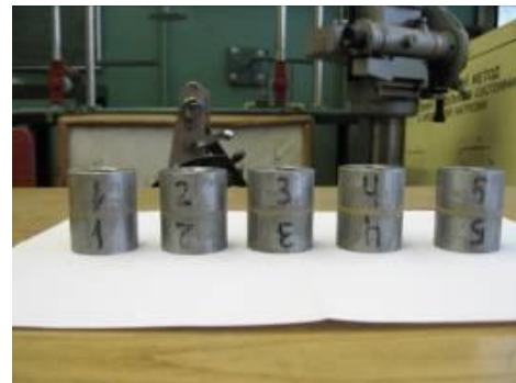
Рис.7. Образцы, подготовленные для испытаний на разрывной машине
