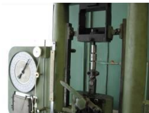
Рис. 9. Разрывная машина с закрепленным в захватах образцом
