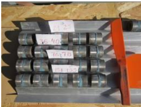
Рис.6. Полимеризация изготовленных образцов
