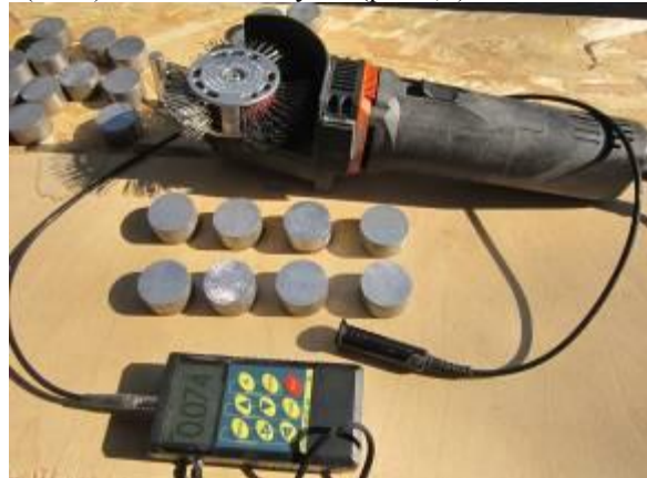
Рис. 5. Зачистка образцов роторной машиной МВХ с контролем шероховатости прибором «Константа 5»
